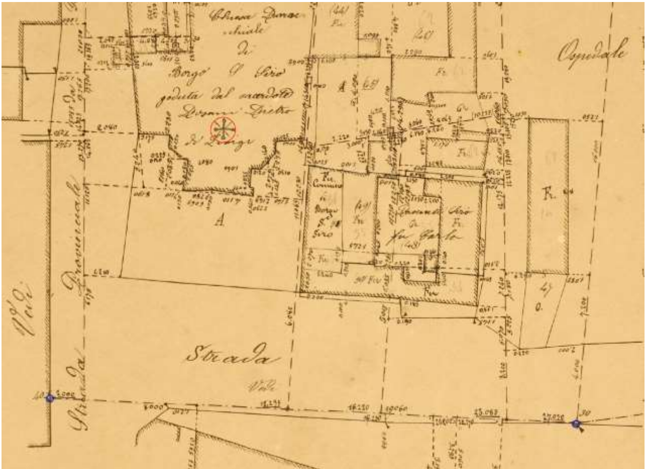
Estratto del medesimo abbozzo di Campagna con evidenziati l'origine del Sistema di riferimento locale, l'asse del Campanile della Chiesa Parrocchiale e i due punti generatori n°30 e N°40
